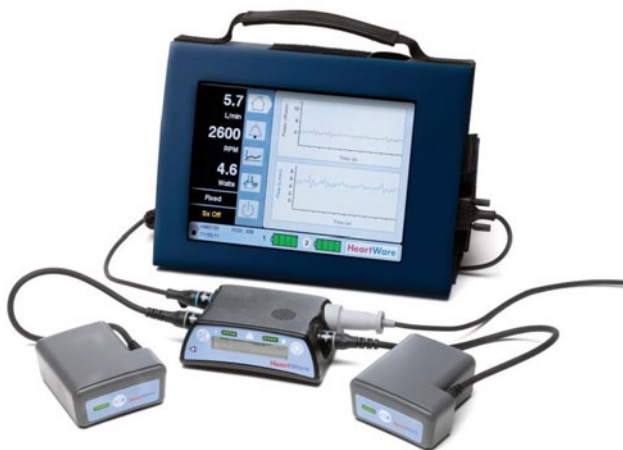
Abb. 5 Controller, Monitor und Akkumulatoren des HeartWare®-Systems [34]
