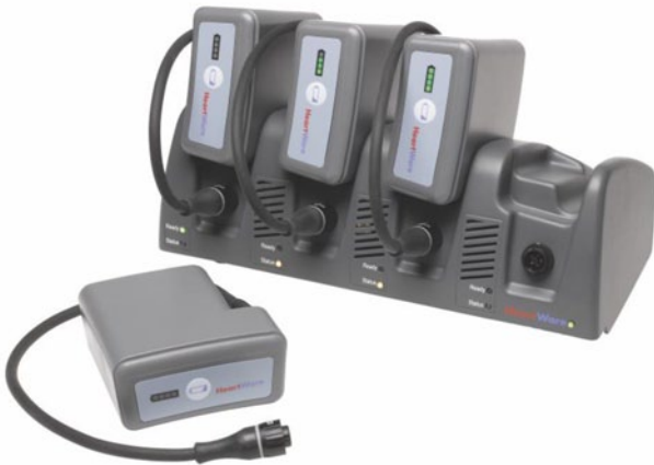
Abb. 4 Ladestation für Akkumulatoren des HeartWare®-Systems [33]
